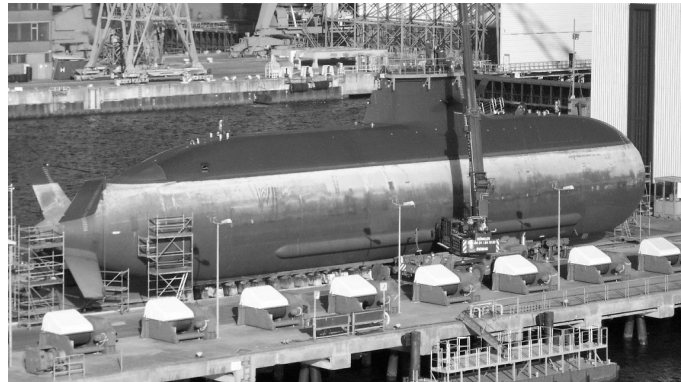
Tyypin 212-sukellusvene. Huomaa aavistuksen kulmikas ylärunko: iso osa aktiivisista sonareista on pinnalla/lähellä pintaa olevia lentokoneista pudotettuja sonopiojuja, joten sukellusveneeseen yläosan häiveominaisuudet ovat kriittisiä. Wikimedia Commons/ Stahlkocher
